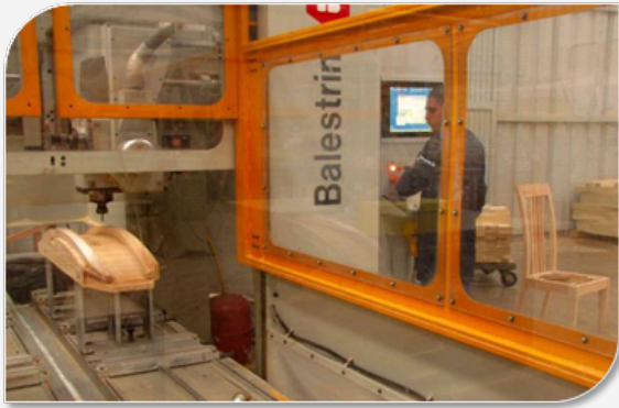
Foto. Centro de mecanizado de control numérico de 5 ejes. IDEA
