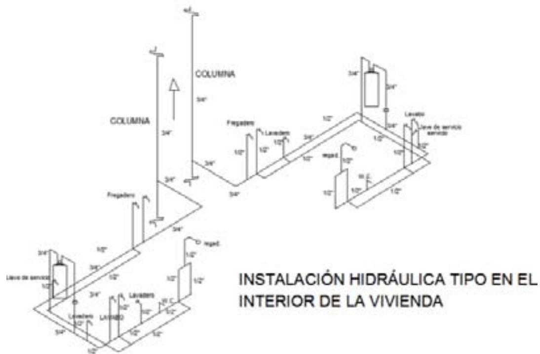
Fig. No5. Isométrico de la instalación hidráulica interior de departamento. Elaboración propia.
