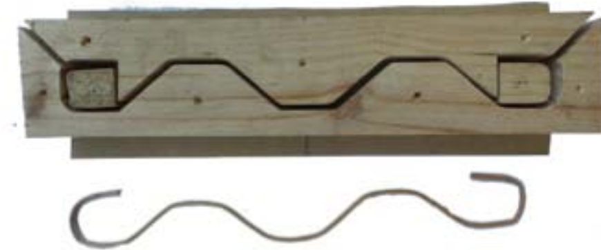
Fig. 15: Imagen de tercera máquina de doblado con resultado en vara.
