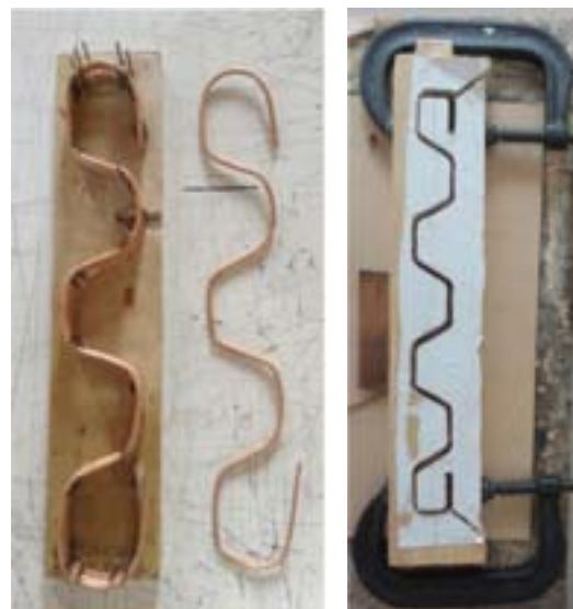
Fig. 11: Máquina de doblado de varilla de mimbre; tabla de madera con clavos. Fig. 12: Máquina de doblado de varilla de mimbre; piezas de madera para prensado de vara.
