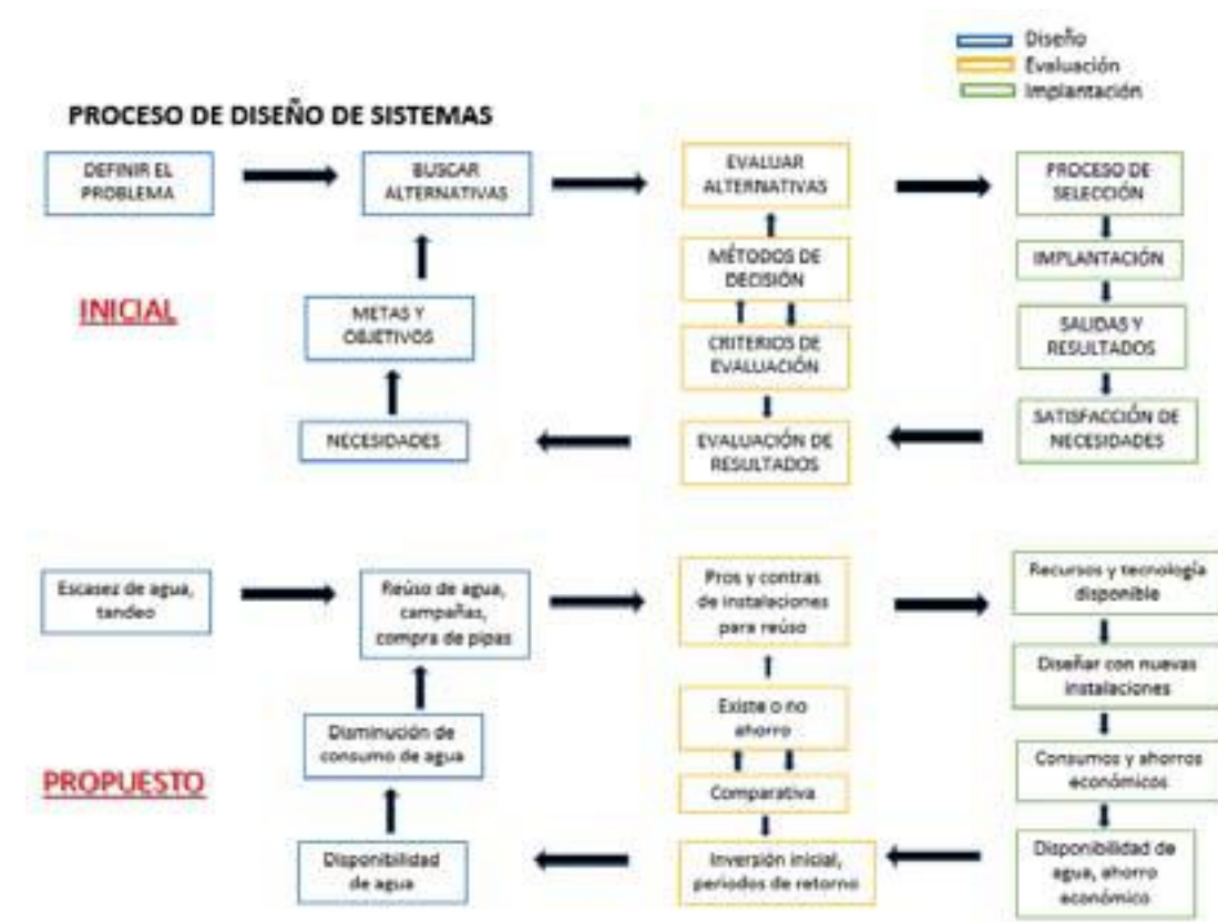
Fig. No.10. Diseño de sistema, agua gris-pluvial. Elaboración propia
