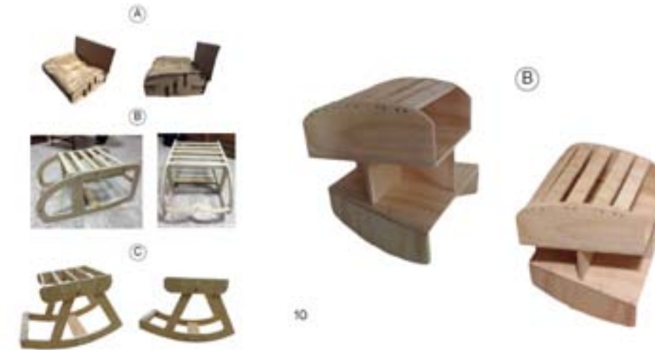
Fig. 6 y 7: Prototipos de dimensiones y curva de muelleo en madera y cartón de las propuestas finales elegidas.
