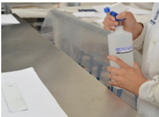
Fig.6 Fotografía tomada durante la aplicación del método de aspersión sobre el reverso de una probeta. Foto tomada por Verónica Díaz
